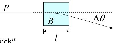
$$p_{\perp} \approx q v B t = q v B (l/v) = q B l$$
